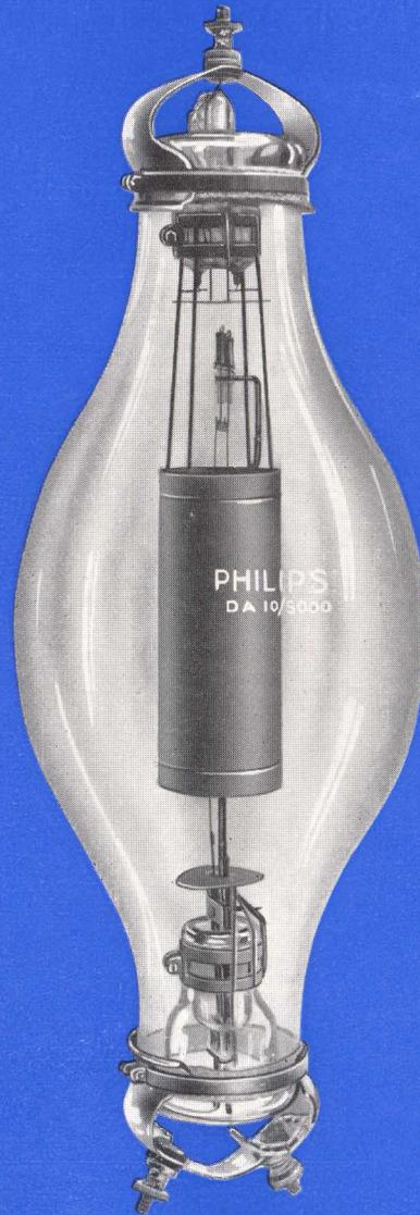
Die Philips Hochvakuumröhre DA 10/5000 für Halbweggleichrichtung zeichnet sich durch einen besonders niedrigen Innenwiderstand aus, so dass die Röhre im Betrieb einen sehr hohen Wirkungsgrad aufweist. Die Anodenwechselspannung und die Gleichspannung können beide von 4000 bis zu 12000 V betragen. Eine Philips Röhre DA 10/5000 genügt zur Anodenspannungslieferung für eine Philips Senderröhre TA 10/2500.
